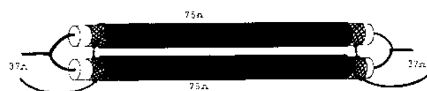
Fig. 53: Două bucăți de coaxial de 75\Omega se pot conecta în paralel, rezultând un „coaxial” de 37\Omega , care se poate folosi la alimentarea antenei Marconi, verticală în \lambda/4 .
